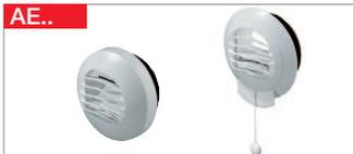
**Bouches d'extraction complètes avec manchettes en plastique.** A emboîter en conduits ND 125. Existe en différentes versions pour diverses utilisations: avec double débit d'air, permanent et complémentaire, ou commande électrique, hygrométrique, temporisée. Les bouches AE et AE GB sont autorégulables. Les bouches type AE Hygro... sont spécialement adaptées aux cuisines et salles de bains.
